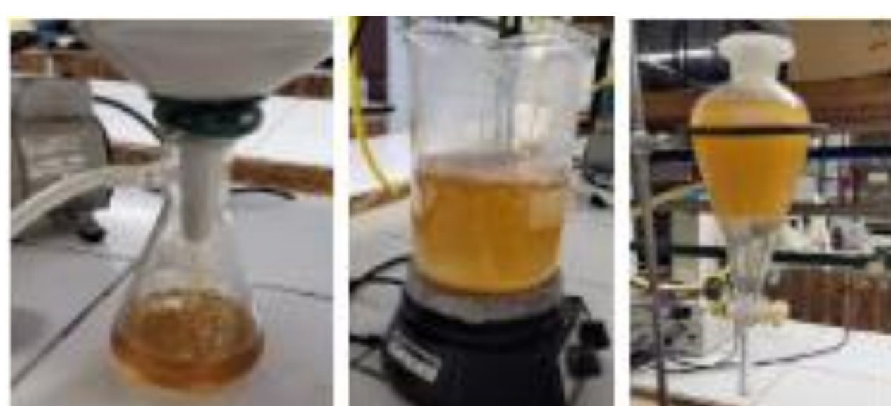
Figura 1. Filtração a vácuo, limpeza e óleo no funil de bromo
