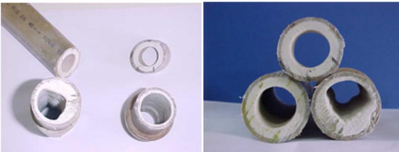
Incrustações nas tubulações como as da Figura 1, podem estar ligadas a condutividade elétrica e pH altos, pois esta é indicativo da presença de sais, como consequentemente estarem relacionadas também, aos níveis de carbonatos de cálcio onde se define a dureza da água.
