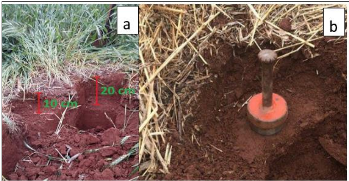
FIGURA 2. AMOSTRAGEM DE SOLO: A) DETERMINAÇÃO DA PROFUNDIDADE DE AMOSTRAGEM; B) AMOSTRAGEM COM ANEL VOLUMÉTRICO.
