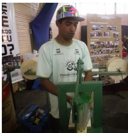
Figura1: Imagem da máquina artesanal para confecção de vassouras pets.
