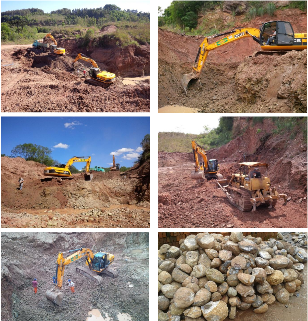
Figura 5: Processo de extração dos geodos. Fonte: Dados da pesquisa.
