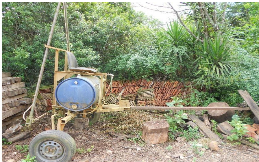
Figura 10 - Pulverizador feito por agricultor quilombola para ser acoplado a junta de bois
