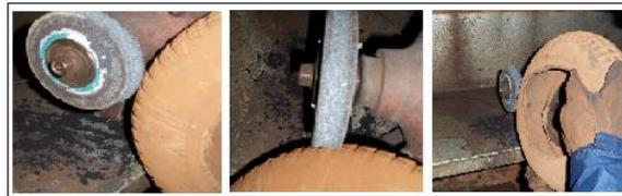
**Figura 1.** Pulverização do pneu.
