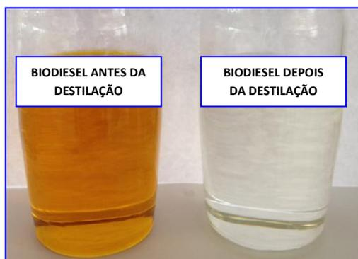
Figura 1: Biodiesel antes e depois da destilação.
