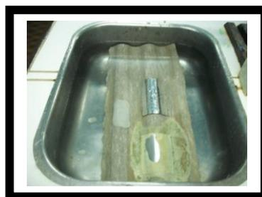
Figura 3: A telha de amianto submersa em água.
