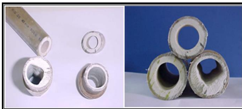
Figura 1. Obstrução de \text{CaCO}_3 em tubulação. Fonte: Peiter: 2010.
